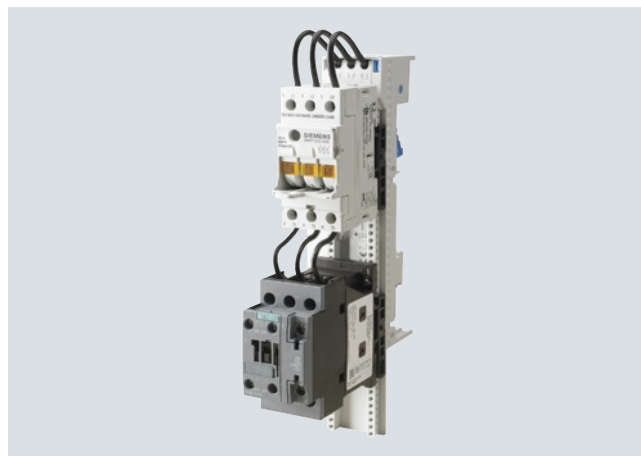
Ensamblaje de portafusibles cilíndricos y contactor SIRIUS sobre adaptador de aparatos para barras colectoras (con 60 mm entre barras)
